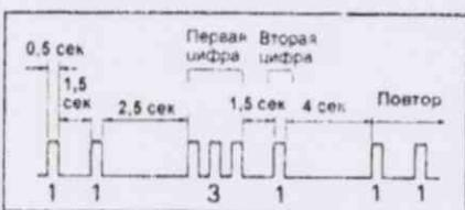
При наличии двух или более кодов неисправностей, они выводятся, начиная с меньшего номера.
