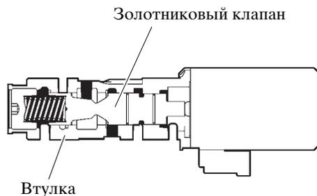
Электромагнитный клапан переключения передач SL2 и SL3
