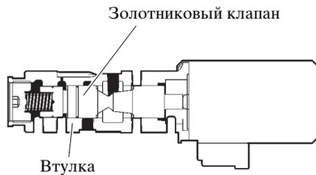
Электромагнитный клапан переключения передач SL1, SL4 и SL5
