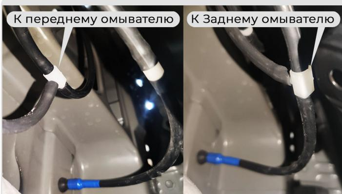
**8** Протяните шланг от тройника к передней камере, закрепите его стяжками на штатной проводке.
