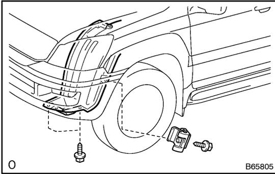
**15. INSTALL FRONT FENDER LINER LH**
