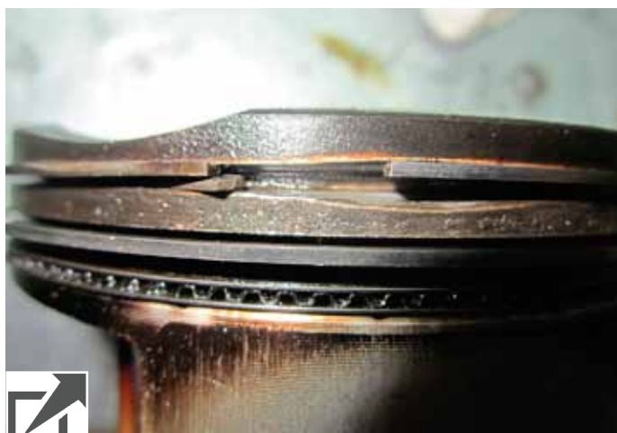
Когда пыль развела канавку верхнего кольца на поршне, кольцо стало вибрировать и в итоге сломалось
