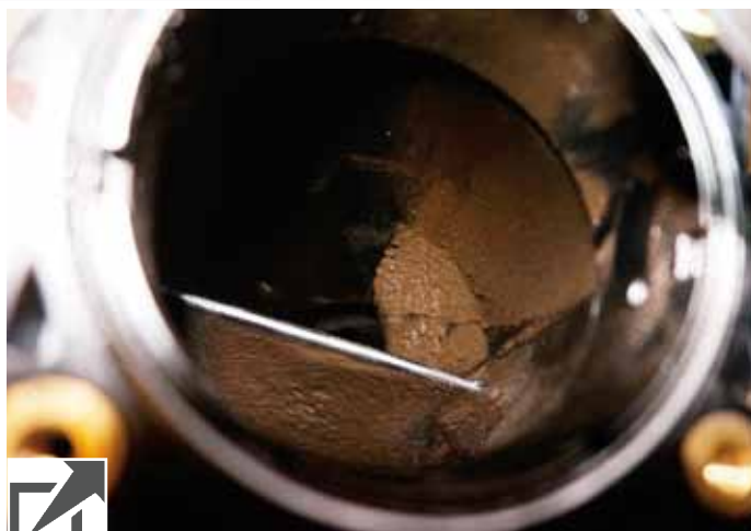
За дроссельной заслонкой во впускном коллекторе – мусорно-пылевая свалка
