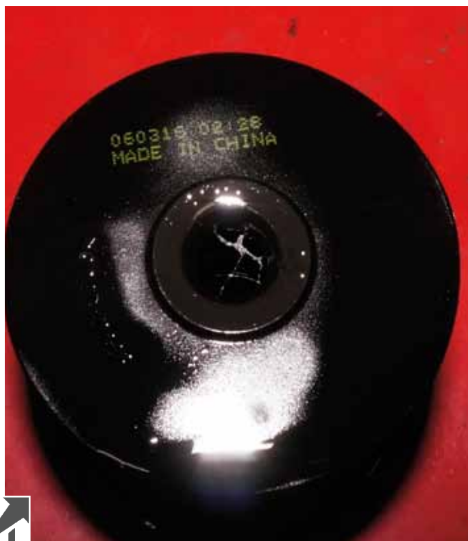
И действительно, при ближайшем рассмотрении в выходном отверстии виден клубок волокон. А там все должно быть стерильно
