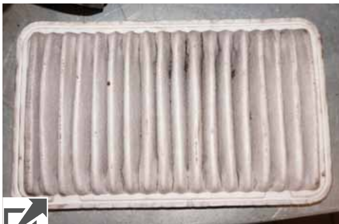
Обычный воздушный фильтр современного автомобиля. Как по его внешнему виду распознать степень загрязненности – непонятно
