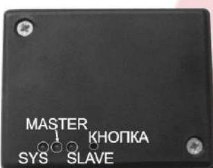
На нижней крышке контроллера размещены светодиоды, индицирующие текущее состояние контроллера.
