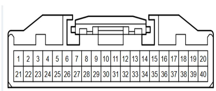
Располагаем фишку лицевой стороной к себе (проводами назад), защелкой вверх и нумеруем контакты слева-направо. Если в фишке два и более рядов контактов, то сначала пронумеровываем верхний ряд слева-направо, затем нижний слева-направо.
