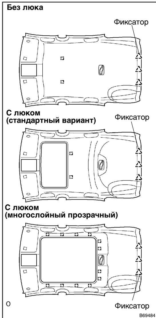
**46. СНИМИТЕ ОБИВКУ КРЫШИ В СБОРЕ**
