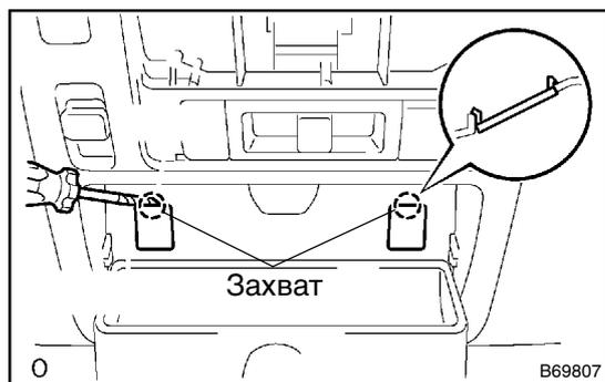
(b) С помощью отвертки освободите 2 захвата и снимите крышку, как показано на рисунке.
