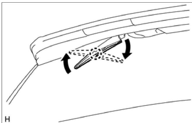
**g. Потяните щетку стеклоочистителя в направлении левого бока автомобиля, чтобы снять ее с рычага.**
