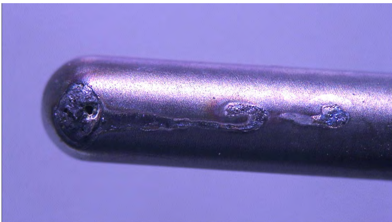
Рис. 25. Следы попадания молнии в правый сигнализатор обледенения
