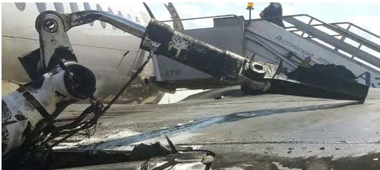
Рис. 15. Внешний вид гидроцилиндра управления правой ООШ
