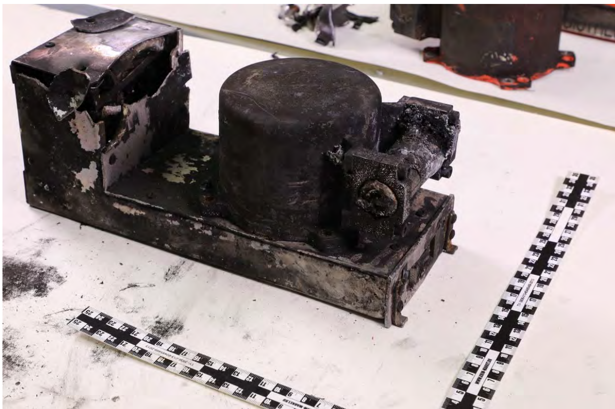
Рис. 30. Общий вид бортового параметрического регистратора L3 FA2100
