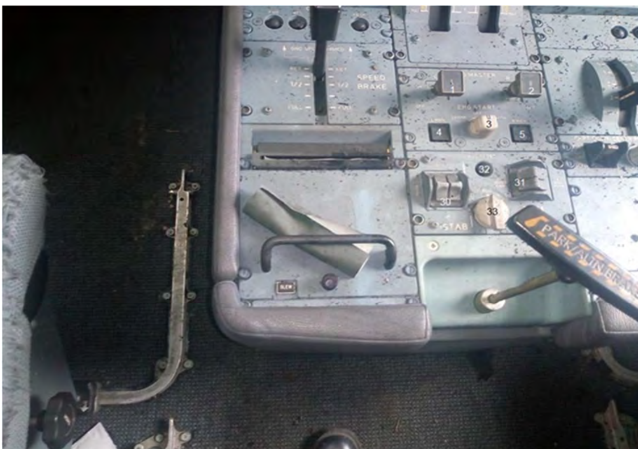
Рис. 20. Состояние переключателей управления двигателями после АП
