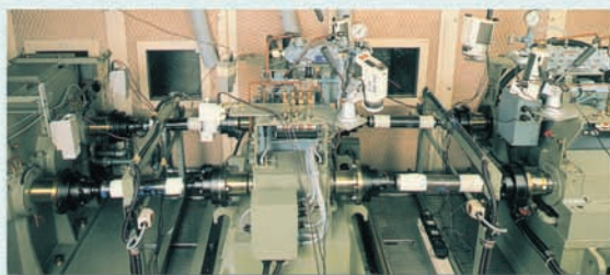
C.V. Joint life testing machine 等速ジョイントの寿命試験
