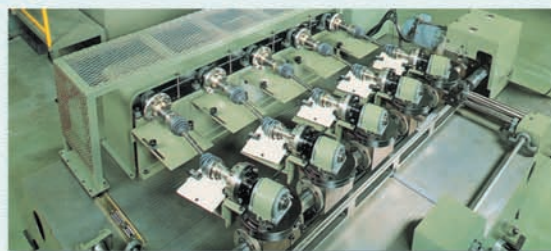
C.V. Joint boots durability testing machine 等速ジョイント用ブーツの耐久試験
