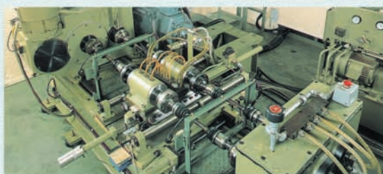
C.V. Joint high speed durability testing machine for propeller shaft プロペラシャフト用等速ジョイント高速試験
