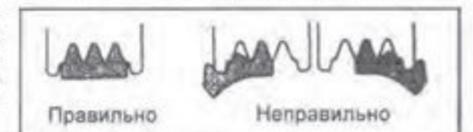
2. Проверьте натяжение ремней привода навесных агрегатов. Надавите на ремень в месте, показанном на рисунке усилием 98Н (10кг) и измерьте прогиб ремня привода.
