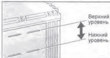
б) С помощью ареометра и термометра измерьте плотность электролита в аккумуляторной батарее.
