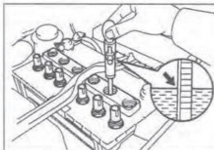
3. Измерьте напряжение каждой аккумуляторной батареи.
