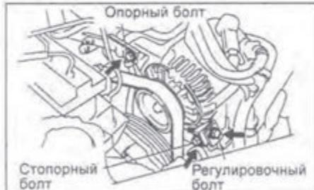
**Ремень привода насоса усилителя рулевого управления**
