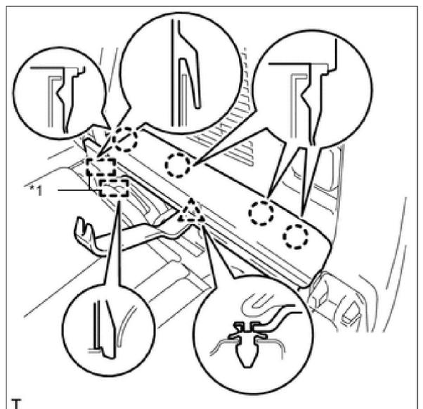
**4. СНИМИТЕ ОПОРНУЮ ПЛАСТИНУ КОВРИКА ЗАДНЕГО ПОЛА**
