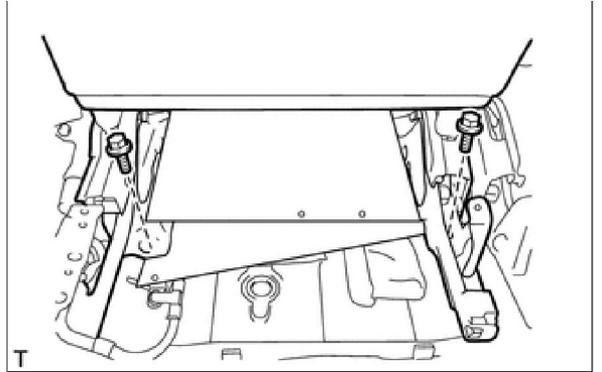
**d. С помощью отвертки освободите 2 направляющих и 6 захватов и откройте 2 крышки.**
