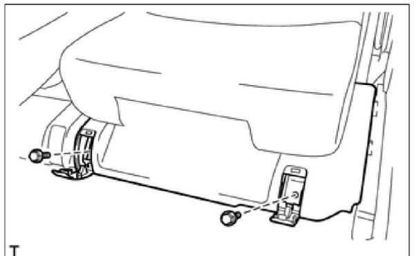
**ф. Снимите заднее сиденье № 2 в сборе с автомобиля.**
