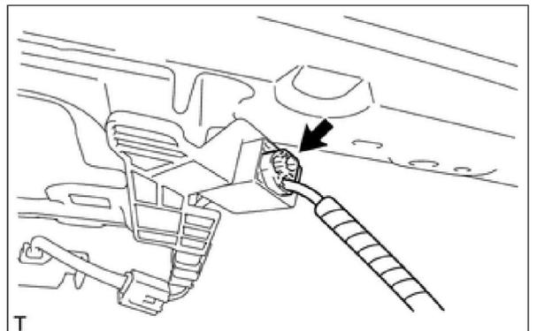
**k. Снимите обивку крыши с двери багажного отделения, как показано на рисунке.**
