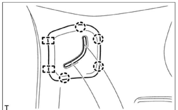
**42. СНИМИТЕ ПРАВУЮ ЗАДНЮЮ БОКОВУЮ ОБЛИЦОВОЧНУЮ ПАНЕЛЬ В СБОРЕ**
