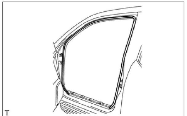
**9. СНИМИТЕ УПЛОТНИТЕЛЬ ОБШИВКИ ПРОЕМА ПРАВОЙ ПЕРЕДНЕЙ ДВЕРИ**
