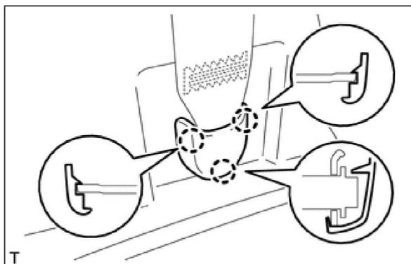
**23. СНИМИТЕ НИЖНЮЮ ОБЛИЦОВочную НАКЛАДКУ ЛЕВОЙ СРЕДНЕЙ СТОЙКИ КУЗОВА**
