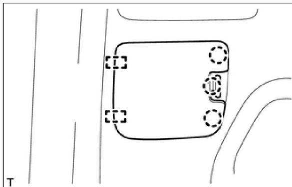
**67. СНИМИТЕ ЛЕВУЮ БОКОВУЮ ОБЛИЦОВОЧНУЮ НАКЛАДКУ ПОЛКИ БАГАЖНОГО ОТДЕЛЕНИЯ**
