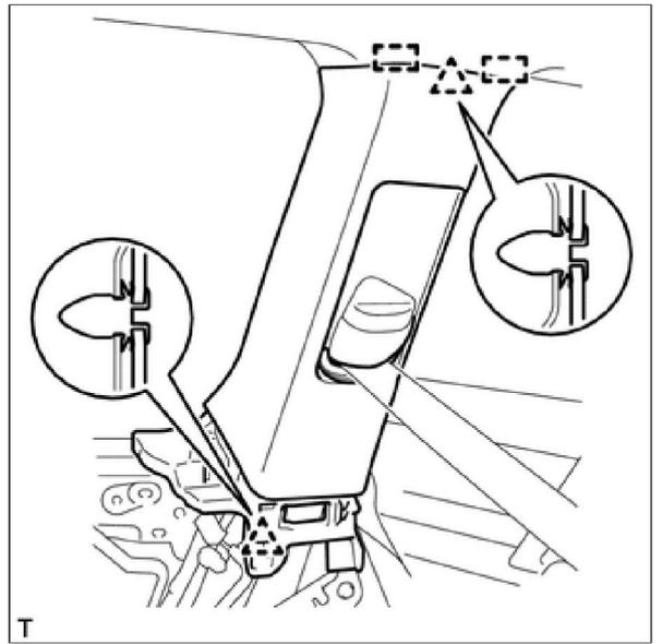
**40. СНИМИТЕ ПРАВУЮ НАРУЖНУЮ ПЕРЕДНЮЮ ОБЛИЦОВОЧНУЮ ПАНЕЛЬ В СБОРЕ**
