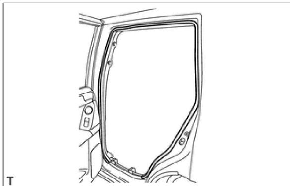
**21. СНИМИТЕ УПЛОТНИТЕЛЬ ОБШИВКИ ПРОЕМА ПРАВОЙ ЗАДНЕЙ ДВЕРИ**
